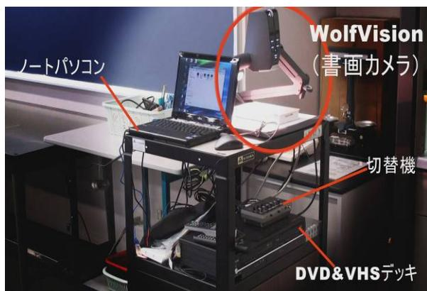
図4 可動式ラックに設置した IT 機器その切替機
